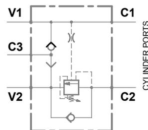
Montaggio su cilindro doppio effetto con distributore a centro chiuso. Mounting on double effect cylinder with closed-center configuration spool valve.
