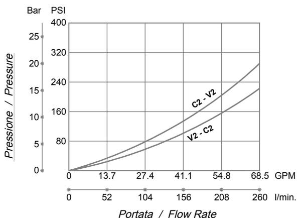
**Condizioni Prova :** Olio minerale con viscosità 16cSt a 65°C.
